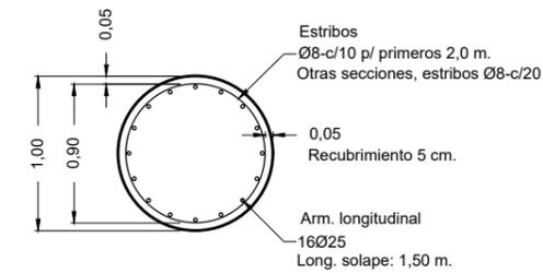
Sección transversal del pilote Ø 1,00 m
