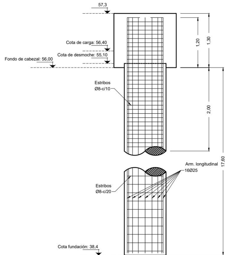
Armadura de pilotes - Puente en prog. 4+277,5
